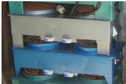
ስዕል 9 - አቶማቲክ ሰርኪዩት ብሬክር ጥቅም ላይ የዋለበት ምድጃ
